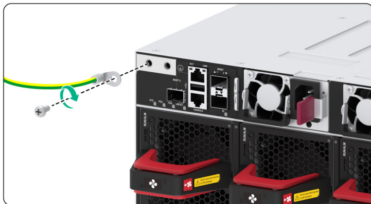
图2-13 安装接地线到 S9800XP-8C-G 接地点示意图
